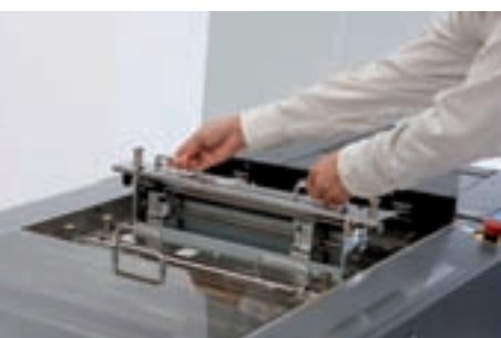
Rimozione del modulo Rotary Tool
