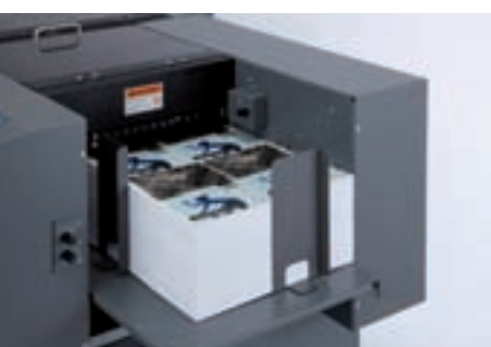
Sistema di alimentazione
